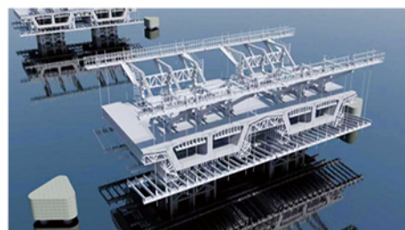
悬浇筑法施工模拟（挂篮）
